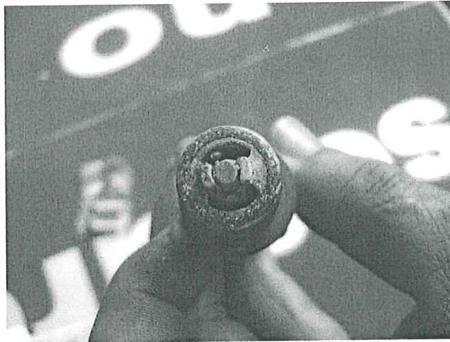
Bujía inferior del cilindro No. 1, corrosión y algo de carbonización
